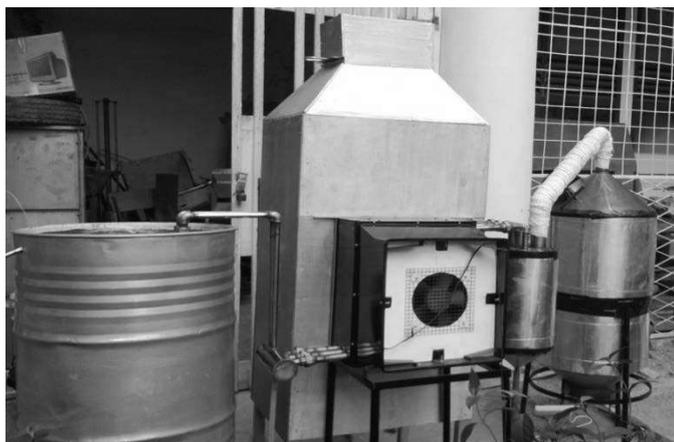
Gambar 5. Unit penghasil asap cair yang terintegrasi dengan pengering kabinet (hasil pabrikasi)
