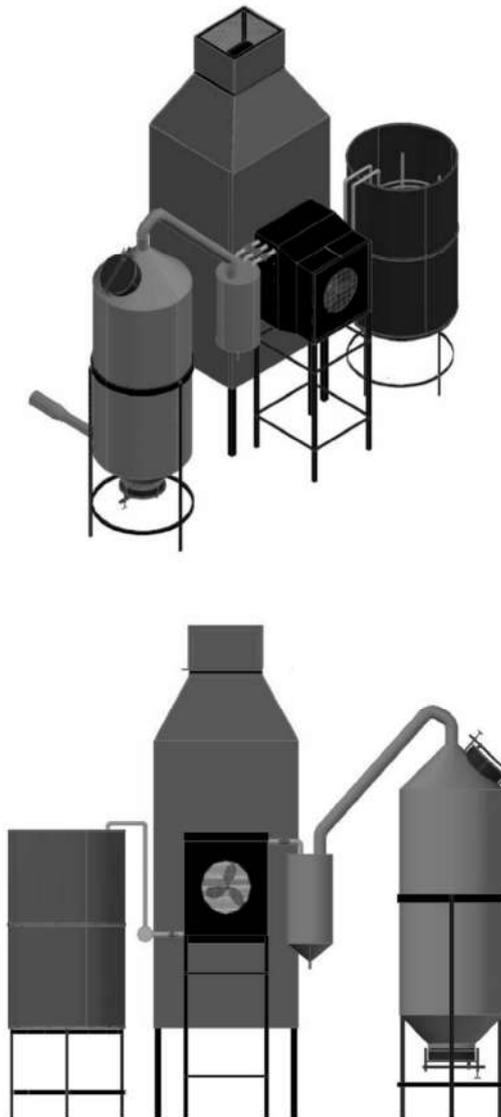
Gambar 4. Unit penghasil asap cair yang terintegrasi dengan pengering kabinet (hasil rancangan)
