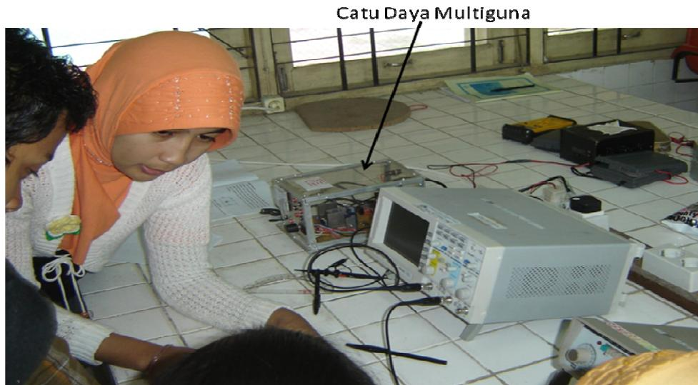
Gambar 5. Pemakaian Catu Daya Multiguna dalam Praktikum Elektronika Dasar
