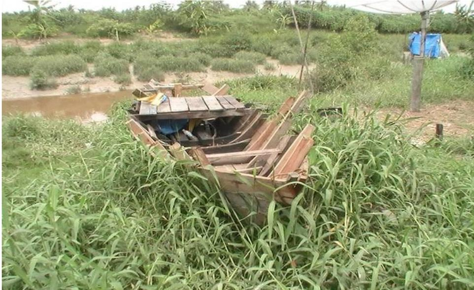
Gambar 7. Kapal motor di galangan kapal tradisional yang tertunda pengerjaannya akibat kekurangan bahan dan dana
