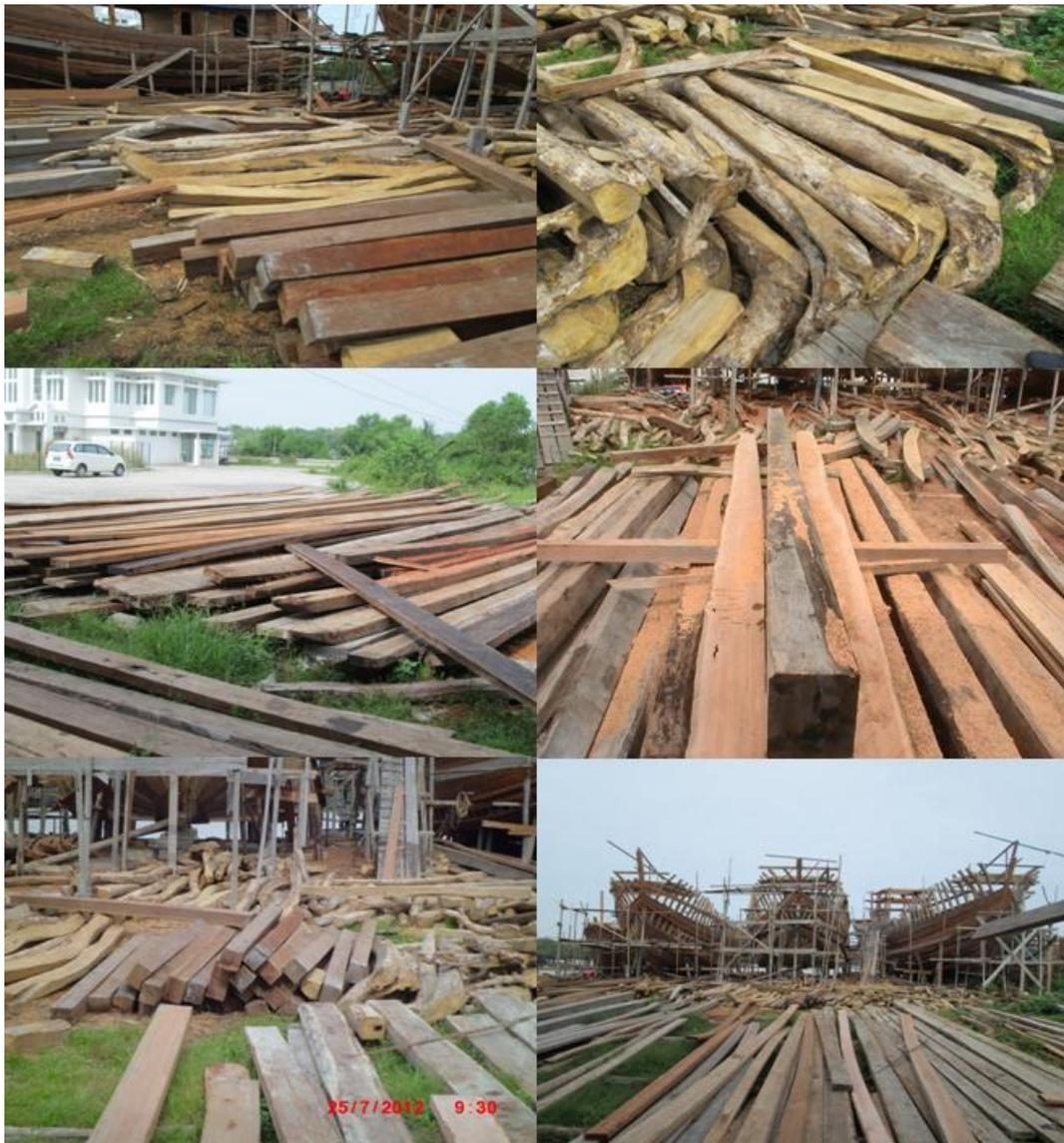
Gambar 10. Bahan baku kayu untuk kapal ukuran 100-350 GT di galangan kapal kayu skala besar di Bagan Siapi-api.
