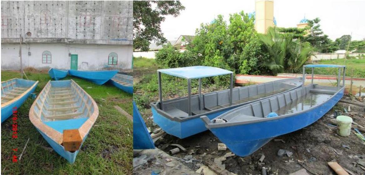
Gambar 13. Konstruksi kapal FRP berukuran 1.5-2 GT yang sedang dibangun di galangan kapal Karya Sakti dan Bengkalis Marine Fiber.
