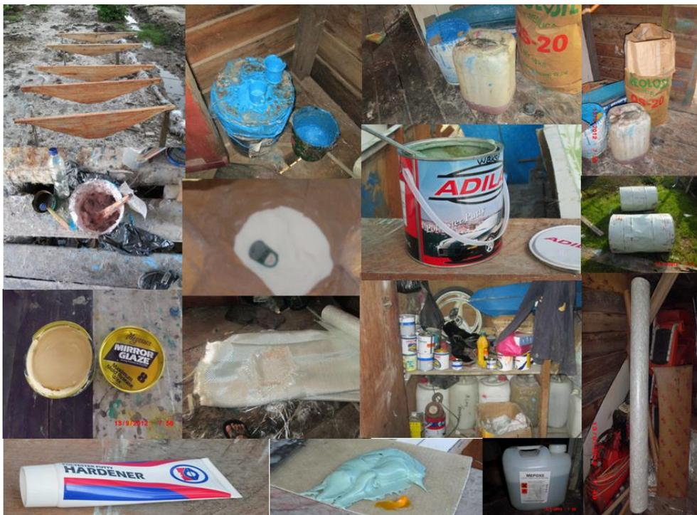
Gambar 17. Bahan-bahan yang dipergunakan dalam pembuatan kapal FRP
