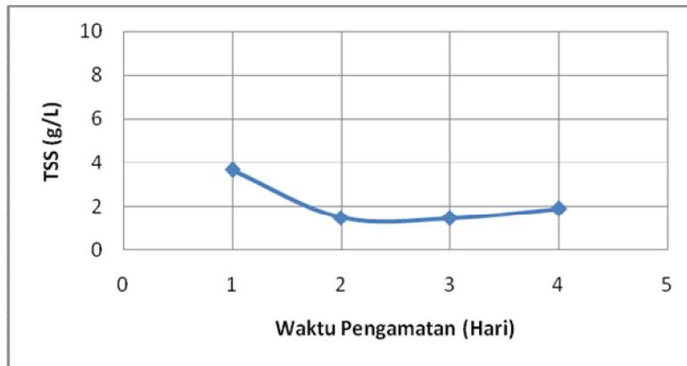
Gambar VI.10 Profil konsentrasi padatan tersuspensi total (TSS) selama proses *start-up* bioreaktor
