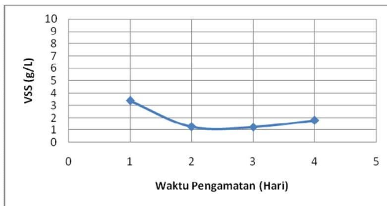
Gambar VI.11 Profil konsentrasi padatan volatil tersuspensi (VSS) selama proses *start-up* bioreaktor
