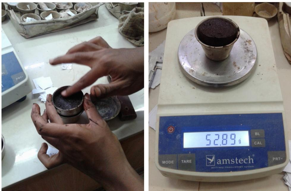
**Gambar 3.5.** Pengujian kadar air dan Berat volume
