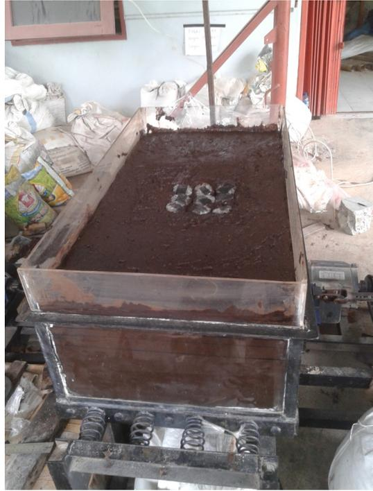
**Gambar 3.17** *Susunan kolom pada pengujian dinamik*
