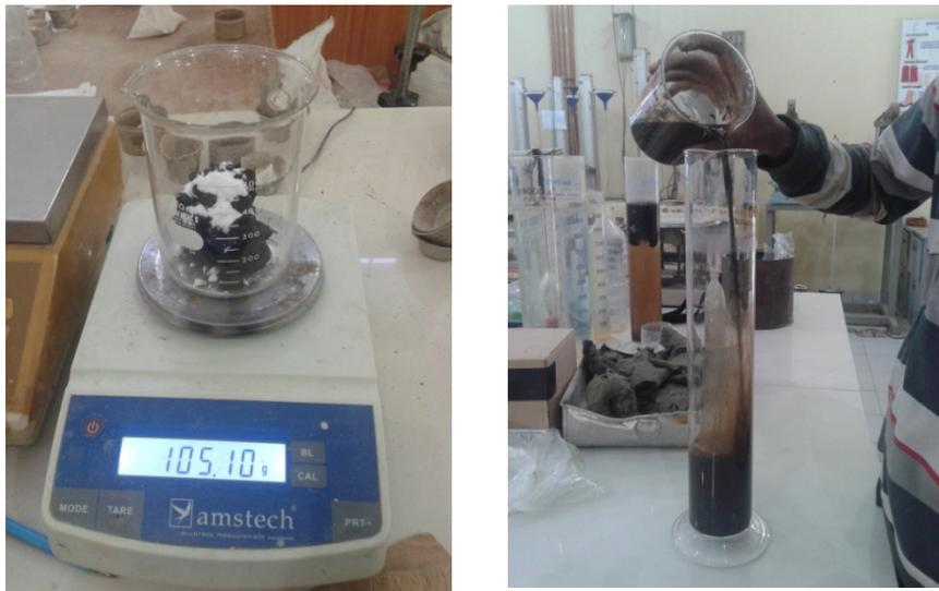
**Gambar 3.6.** Pengujian Kadar Serat Gambut
