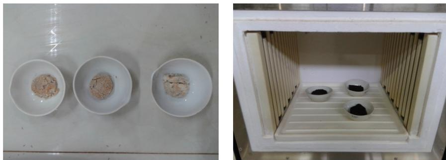
**Gambar 3.7.** Pengujian Kadar Abu dan Kadar Organik
