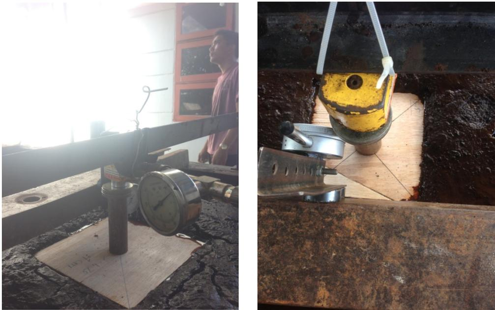
**Gambar 3.16.** Pembebanan dan penurunan dengan pola segiempat
