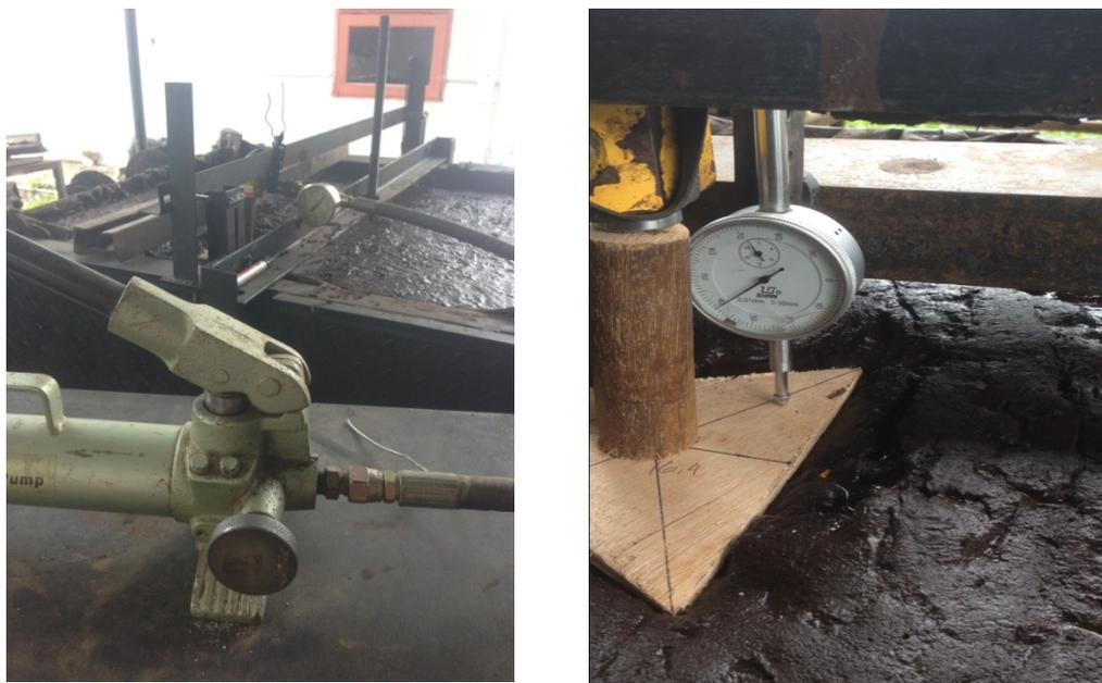
**Gambar 3.12.** *Pembebanan dan penurunan dengan pola segitiga*
