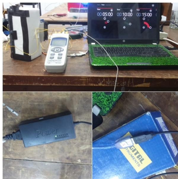
**Gambar 4.6** Pengujian dengan menggunakan adaptor sebagai daya utama
