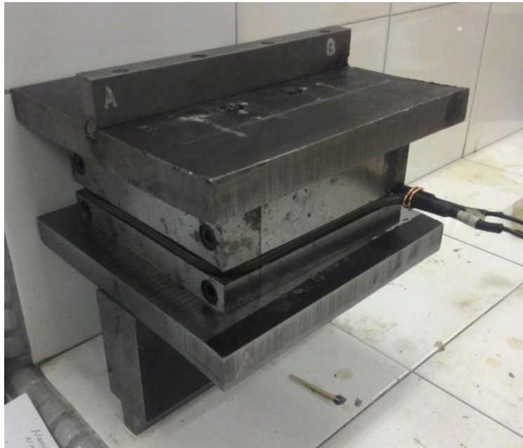
Gambar 5.1. Kompaktor Pelat Komposit Kanvas Rem Cakram
