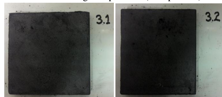
Gambar 5.16. Pelat Komposit Kanvas Rem Cakram dengan Pengisi Terak Limbah Tandan Kosong Kelapa Sawit (Komposisi 3)
