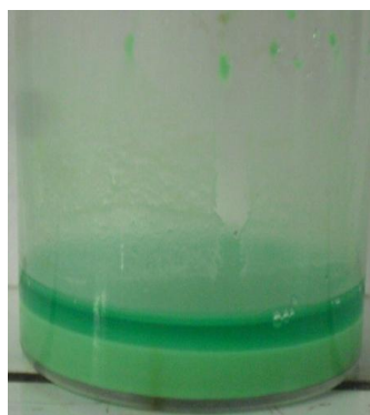
Gambar 4. Terbentuknya endapan pada campuran larutan nikel nitrat dan urea
