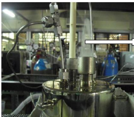
Gambar 2 Pembentukan Gas Hidrokarbon dari Hasil Gasifikasi Limbah PET (T = 350°C, P = 1 atm, Laju Alir Argon = 90 ml min, and t = 20 min)
