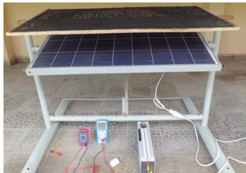
Gambar 1. Set up percobaan untuk mengukur kurva I(V) modul fotovoltaik silikon polikristal Hooray MCP-2 dengan pemasangan screen pada permukaan modul
